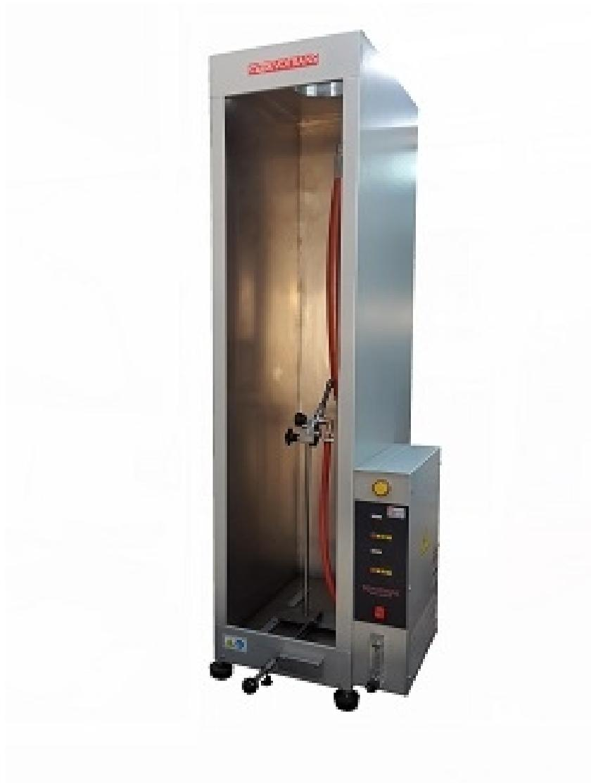
UTILISE POUR TESTER LA RESISTANCE DES CABLES AU BRULAGE
